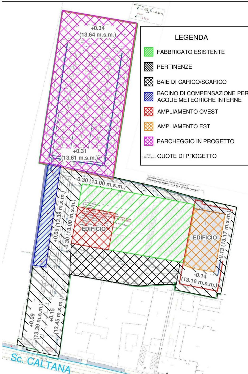
Figura 5.2 - Area Kioene S.p.A.: dati altimetrici previsti per le diverse parti dell'area stessa, dedotti dall'elaborato 02IDR relativo allo stato di progetto.
